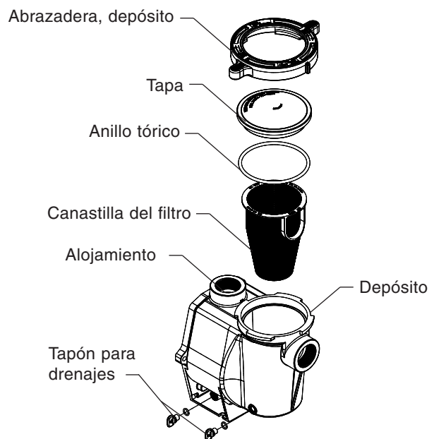
Conjunto del depósito del filtro
